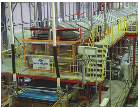
写真 6-8 連続プレス装置（提供：日本ノボパン工業（株））
