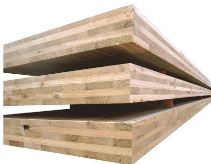
写真 6-16 150mm 厚の CLT（直交集成板、提供：日本 CLT 協会）
