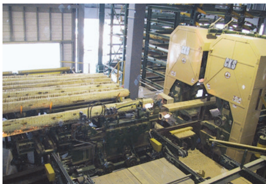
写真 6-6 コンピュータ管理による大型製材機械（十和田湖町森林組合（現 上北森林組合木材加工センター）で撮影） (3)
