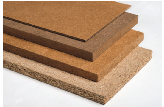
写真 6-13 各種のボード類（上から順に、ハードボード、MDF、インシュレーションボード、パーティクルボード、提供：日本繊維板工業会）
