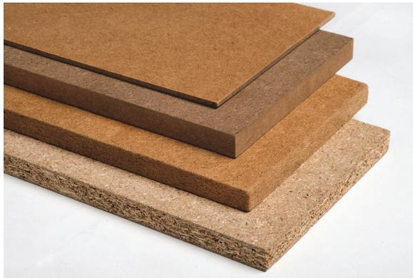
写真 13 各種のボード類（上から順に、ハードボード、MDF、インシュレーションボード、パーティクルボード、提供：日本繊維板工業会）
