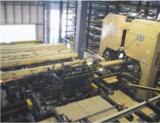
写真 6 コンピュータ管理による大型製材機械（十和田湖町森林組合（現 上北森林組合木材加工センター）で撮影）<sup>③</sup>
