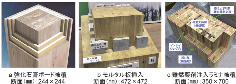
図 11 国土交通大臣の認定を受けている耐火集成材の例
